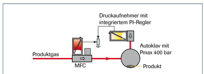
Durchflussregelung wird oft kombiniert mit der Regelung des Reaktordrucks über einen EL-PRESS Vordruckregler, oder wie abgebildet, einem EL-PRESS Druckmesser mit integriertem PI-Regler. Typische Anwendungen: Hochdruck-Hydrieranlagen und Autoklavenprozesse unter Einsatz eines PN400 Massedurchflussreglers mit Vary-P-Regelventil.
