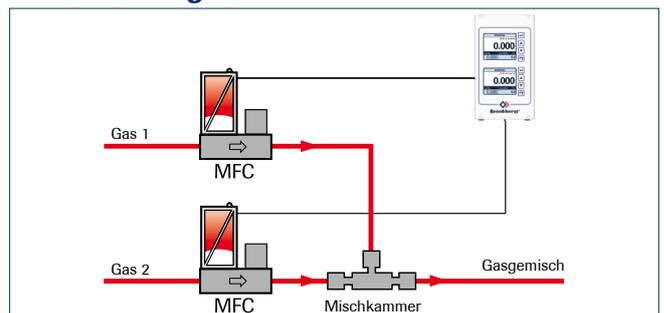
MFC's werden oft für die präzise und stabile Herstellung von Gasgemischen eingesetzt. Bronkhorst® Auswertesysteme mit integrierter Stromversorgung bieten die Möglichkeit einer Verhältnisregelung (Master/Slave) wobei das Verhältnis der Mischgase konstant gehalten wird. Im obigen Beispiel ist der Regelbereich des einen Gases viel kleiner als des anderen. Für solche Anwendungen hat Bronkhorst eine Gasmischkammer entwickelt, die ein homogenes Gasgemisch auch bei schwankenden Drücken sicherstellt.
