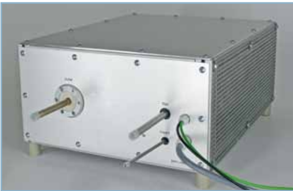
Sprayverdampfer mit Trägergas und Temperierung
