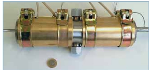
Abbildung B: Temperierstufe mit integrierter Verteilung
