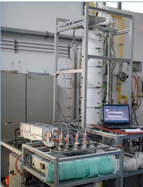
Reaktor mit Dampfdosierung und Gaseinspeisung
